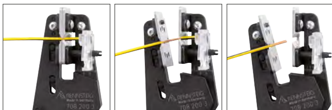
Colocar el cable en el tope longitudinal Position cable at length stop
