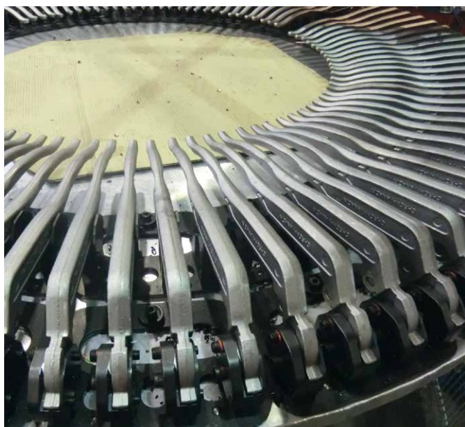
Fabrication automatisée de pinces à tubes, pieds de biche et burins Fabricación automatizada de tenazas para tubos, desencofradores y cincheles
