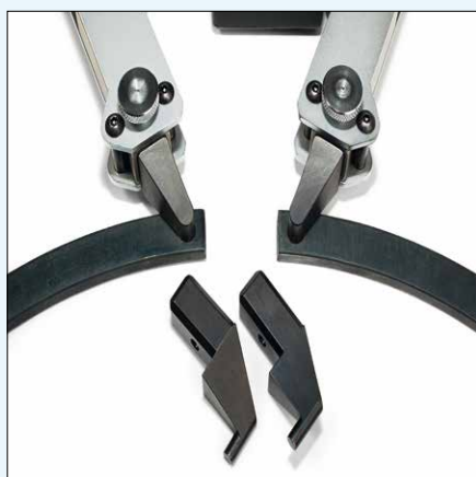
Embouts remplaçables pour les bagues intérieures et extérieures
