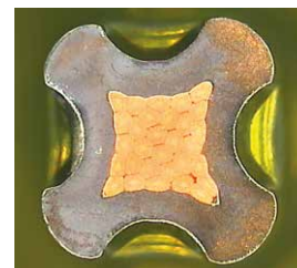
Section transversale d'un sertissage à quatre points Sección de un crimpado de cuatro mordazas
