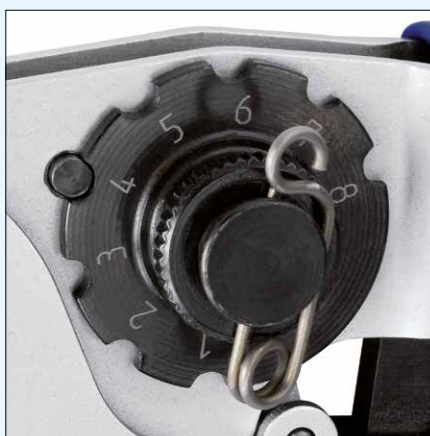
Réglage des poinçons de sertissage par sélecteur avec 8 positions selon MIL/SAE AS22520
